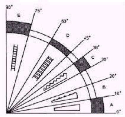
Legenda: A: rampa. B: rampa com peças transversais para evitar o escorregamento.
