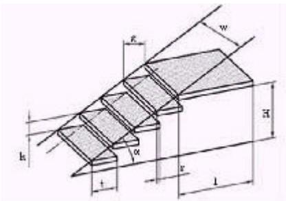
Figura 3: Exemplo de escada fixa do tipo marinheiro.
